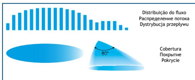
Para um volume de distribuição correto e uma cobertura perfeita, é necessário que o bico AOC seja de medida inferior àquela dos outros bicos usados na barra. Ex.: se forem utilizados CFA11004 na barra, o bico terminal correto é o AOC03.
