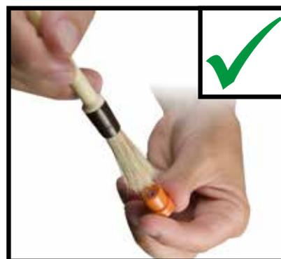
Os bicos tipo leque ou com fenda são assim chamados, pois criam um jato plano devido à forma particular da cabeça na qual o furo de saída possui a forma elíptica ou retangular.
