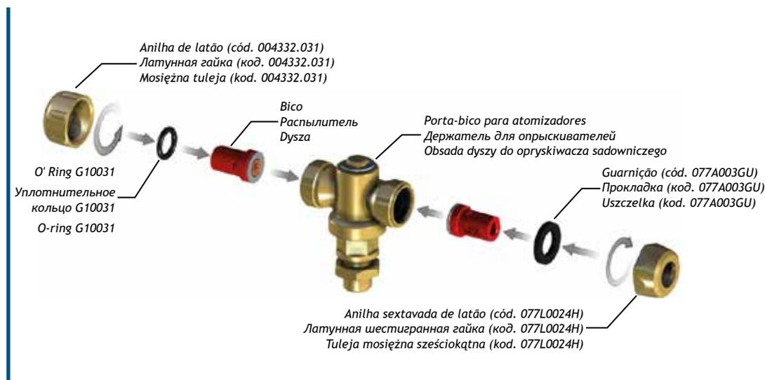
O torque de aperto recomendado vai de 5 a 10 Nm. Esse dado refere-se unicamente à utilização de uma anilha roscada e não à utilização de uma cabeça com engate rápido
